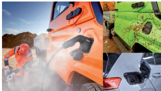
Obr. 3 Vysoká trieda ochrany IP: nabíjacie zásuvky od spoločnosti Phoenix Contact poskytujú úplnú ochranu pred vlhkosťou, nečistotami, prachom a kontaktom aj v náročných podmienkach.
