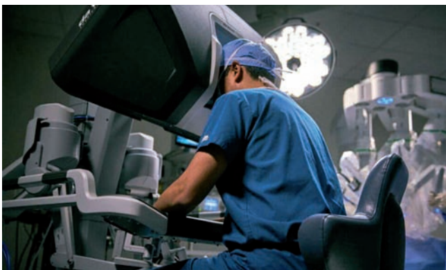
Da Vinci je viacramenný endoskopický operačný systém simulujúci pohyby ľudských rúk v tele pacienta. (Zdroj: Penta Investments)
