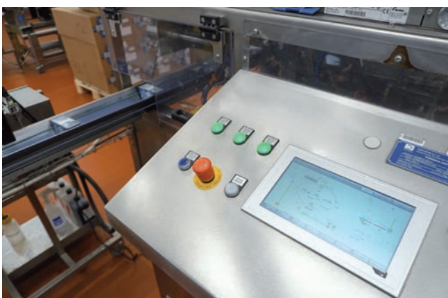
Obsluha linky má možnosť na lokálnom HMI paneli sledovať priebeh výroby či nastavovať rôzne parametre.
